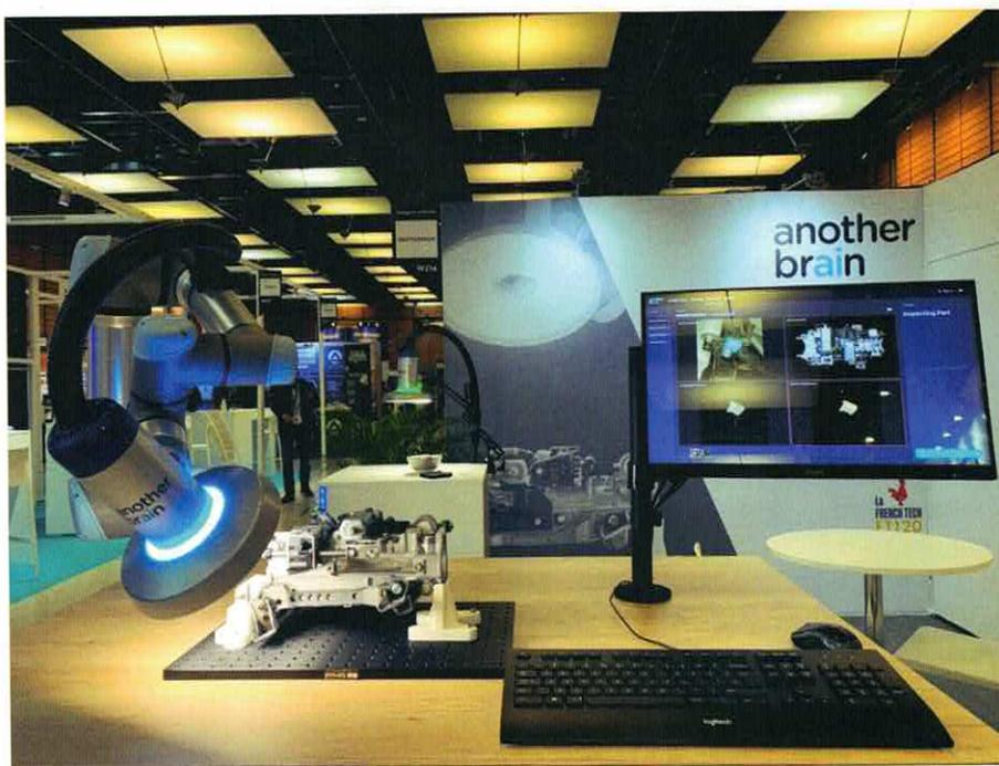
Outre ces bénéfices, la solution s'intègre facilement sur les lignes de production des clients, sans besoin de qualification pour les opérateurs. Dotée d'une interface intuitive, elle détecte les défauts à partir d'une dizaine de pièces répondant aux normes qualité et est capable d'expliquer ses décisions, ce qui la rend unique.
