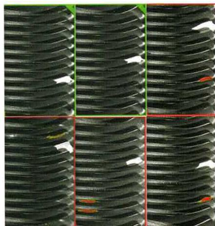
Illustrations de détections de chocs, de déformations, de manque matière, sur les pales d'une roue de turbine à forte variabilité d'aspect
